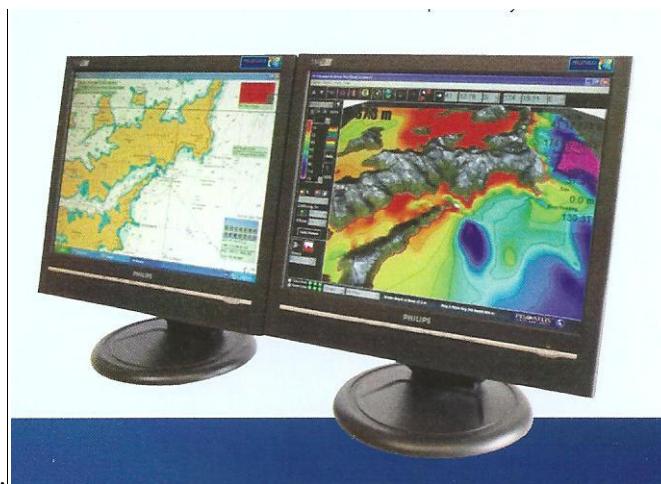
Picture 01: Промыслово-навигационное оборудование OKEANtechnology™: навигационная электронная картография (CplotPRO+Стар)+ программное обеспечение объемной промысловой навигации Picstaus3D + данные объемной топографии дна океана дальневосточного региона России.
